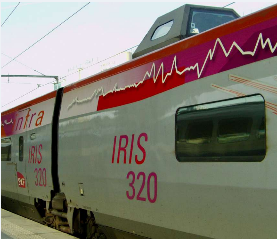
▲ Rame de mesures à grande vitesse IRIS 320
