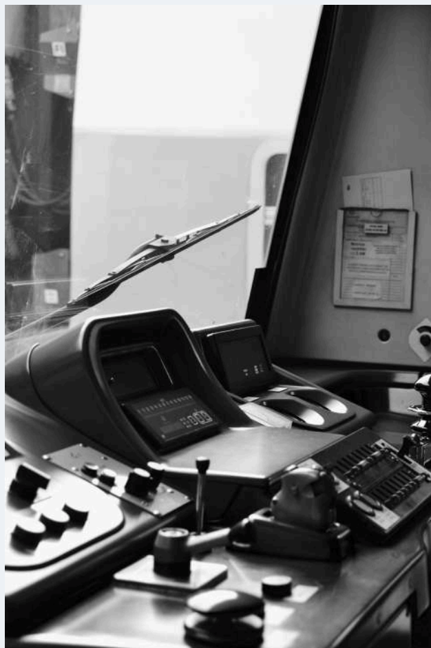
▼ Pupitre de conduite d'une rame MS61
